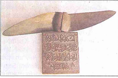
Hezarfen Edhem Efendi'nin Özbekler Tekkesi'nde imal ettiği (1290/1873) buhar makinesinin plakası ve makineye taktığı pervane
